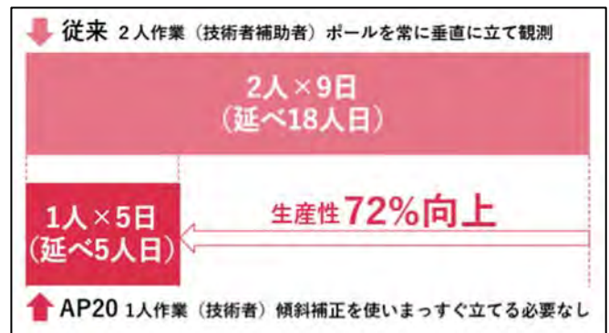
図2: 従来方法とAP20使用時の測量作業比較
